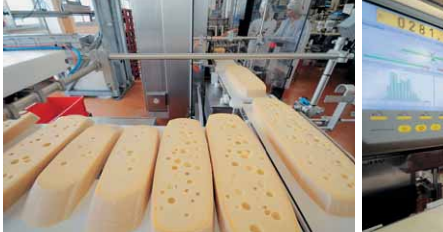
Aus Emmentaler-Laiben macht die vollautomatische Maschine Riemen, schneidet daraus Portionen und schickt diese über die Waage zur Schweissstation, wo der Käse in Plastik verpackt wird.
